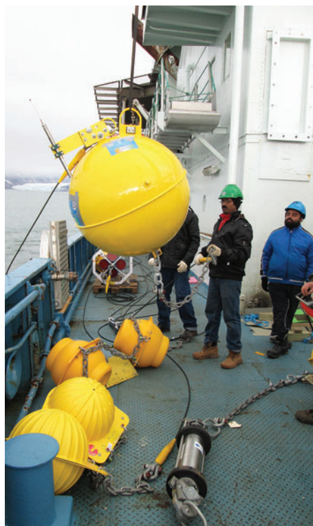
Запуск мультисенсорной заякоренной буйковой станции IndARC.
