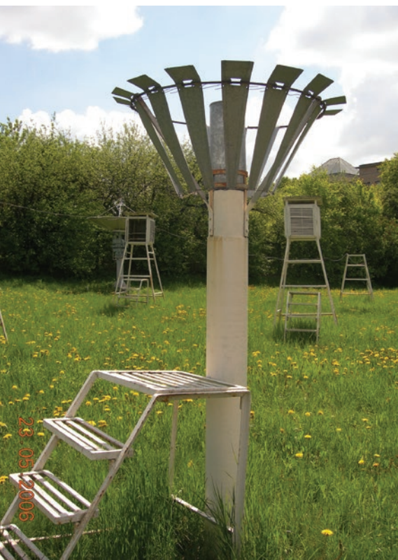
Осадкомер с защитой Третьякова введен вместо дождемера с защитой Нифера к середине 1950-х гг., так как позволял получать более достоверные данные о количестве твердых осадков.
