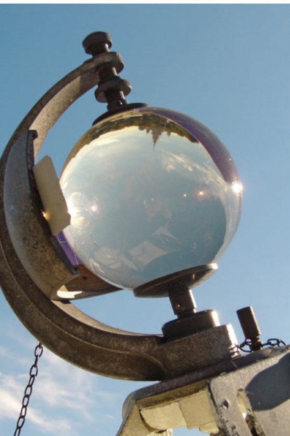
Гелиограф Кемпбелла-Стокса – прибор для регистрации продолжительности солнечного сияния. Он используется в метеорологии больше ста лет. ФОТОГРАФИИ: АРХИВ МЕТЕОРОЛОГИЧЕСКОЙ ОБСЕРВАТОРИИ МГУ
